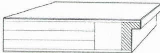
TYPE 50, DOOR THICKNESS APPROX. 50 MM Fire prevention door T30 (E130) Smoke protection door RS (S200) Burglary prevention door RC2 Soundproof door SK27/1
